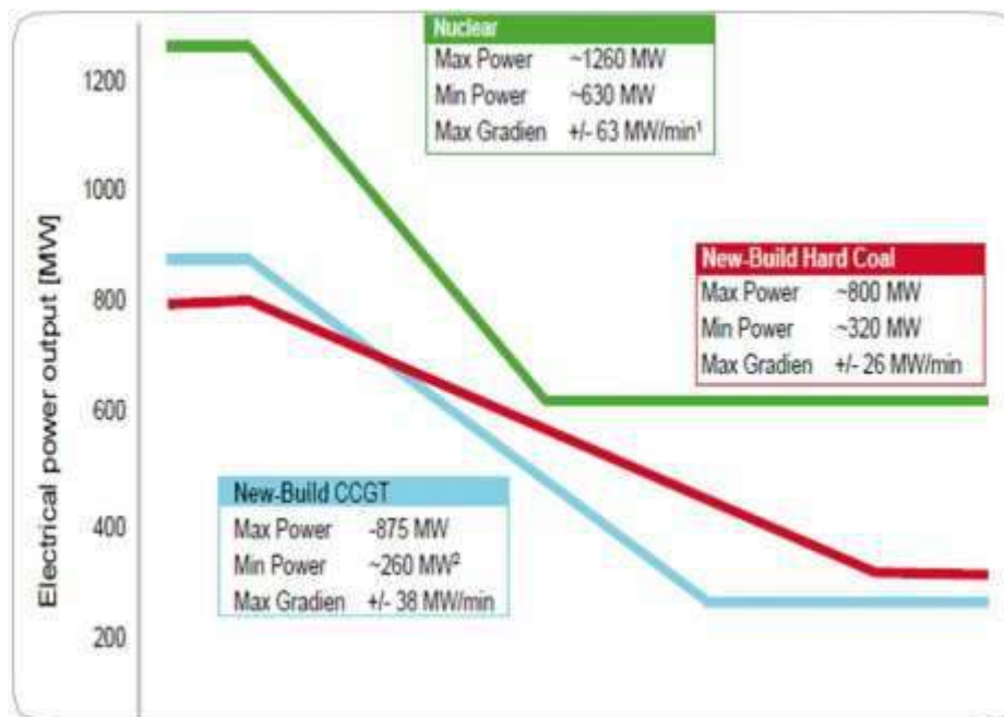
Rysunek 31 Porównanie szybkości zmiany obciążenia (mocy) w różnych typach elektrowni systemowych
