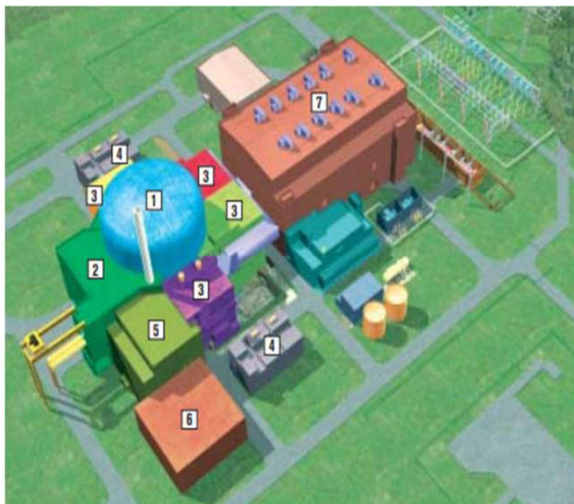
Rysunek 32 Główne budynki elektrowni jądrowej EPR
