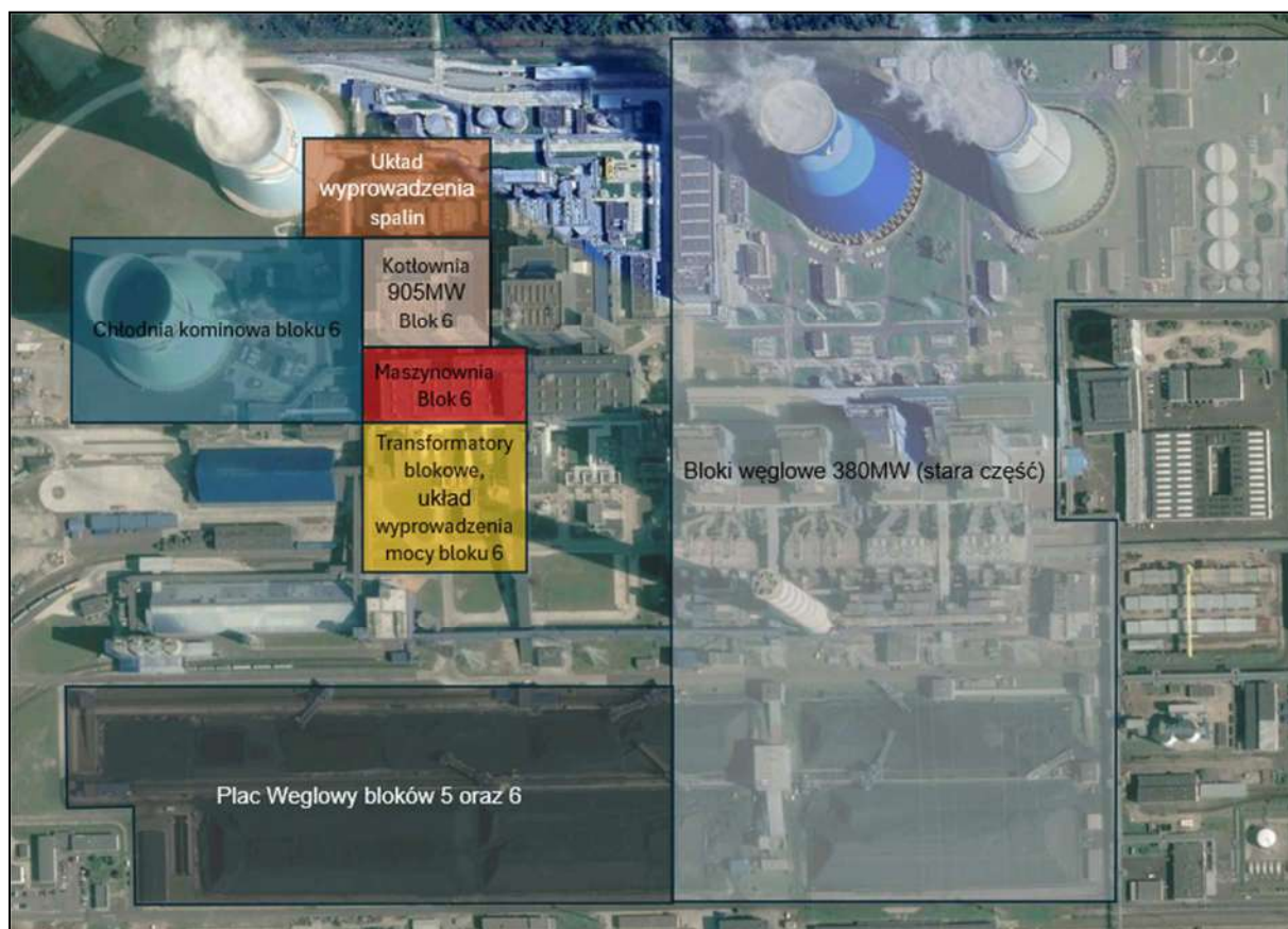
Rysunek 15 Lokalizacja głównych obiektów Elektrowni Opole
